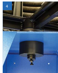
REEL ROLLER MECHANICAL BRAKE FRENO MECCANICO SBOBINATORE
