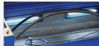
WATER VERSION WITH CHAMBER AND COMPONENTS IN STAINLESS STEEL VERSIONE AD ACQUA CON VASCA E COMPONENTI IN ACCIAIO INOX
